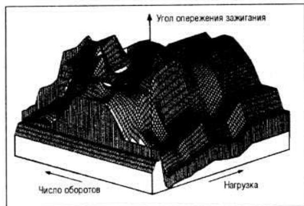
Необходимые характеристики для регулирования системы (т.е. оптимальные значения, используемые компьютером) определяются опытным путем на испытательном стенде, а затем уточняются при ходовых испытаниях автомобиля. В итоге это дает наиболее благоприятные значения расхода топлива, состава отработавших газов и других характеристик двигателя при любом режиме его работы.
