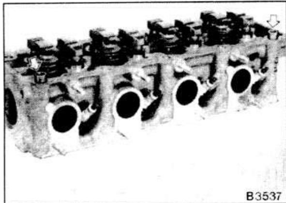
**Внимание!** Перед установкой корпуса распределительного вала вставить в головку цилиндров центрирующие втулки.
