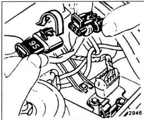
Регулировка опережения зажигания производится путем перестановки разъема в моторном отсеке автомобиля в другое положение. Таким образом, можно перейти, например, с этилированного бензина 98 на неэтилированный бензин 95 или с неэтилированного бензина 95 на неэтилированный бензин 91 и наоборот с сохранением максимальных характеристик двигателя при любом режиме работы.
